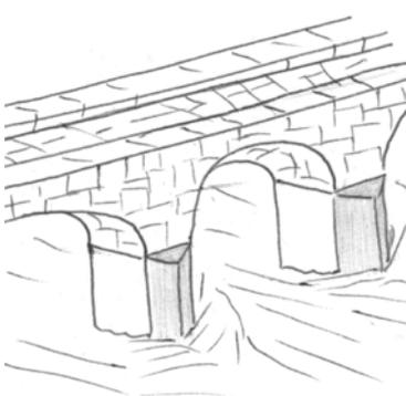
uidos precisamente para salvar tales accidentes típicos de cada zona, en cada pilar rectangular que sostiene un arco u ojo del puente, le construían un pequeño pilar adosado, el cual tenía forma de quilla de barco para que el agua circundara el pilar sin erosionarlo, por lo que el pilar adosado lo colocaban a contracorriente.
